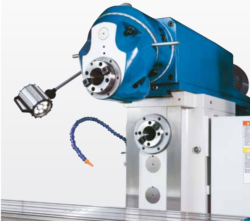
Универсальная поворотная головка и горизонтальный шпиндель
